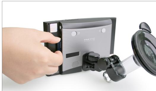
2. マイクロ SD カードアダプターが正常に挿入された場合、マイクロ SD カードアダプターの先端のみが見えます。
