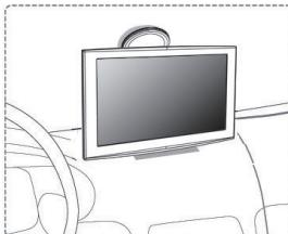
오랜 시간 유리 흡착식 거치대를 사용하면 흡착력이 약해져 약한 차량 진동에도 제품이 흔들리거나 유리면에서 떨어져 파손될 수 있습니다. 따라서 흡착력이 충분한 상태로 장착되어 있는지 자주 확인해 주십시오.
