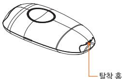
(1) 그림상의 탈착 홈을 이용하여, 손톱으로 배터리 커버를 빼내십시오.
