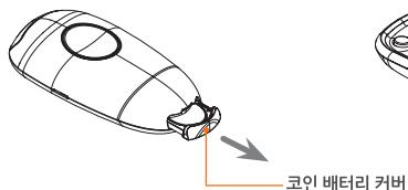
(2) 빼낸 코인 배터리 커버에 코인 배터리를 그림과 같이 (+) 표시가 위로 향하게 하여 조립 하십시오.
