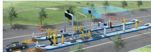
단말기(OBU)에 하이패스카드를 삽입 후 무선통신(적외선 또는 주파수)을 이용하여 하이패스 차로를 30km/h 이하로 무정차 주행하면서 통행료를 지불하는 최첨단 전자요금수납시스템으로 필요장비는 단말기(OBU)와 하이패스카드(선·후불)이다.
