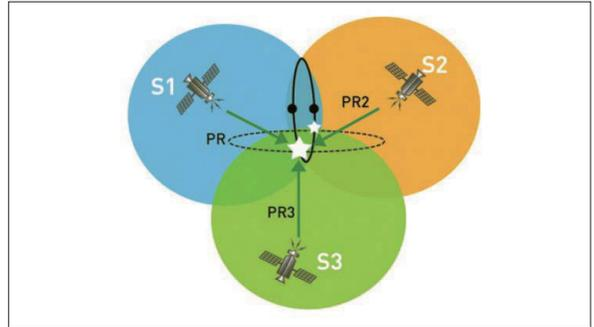
의사거리는 비교적 낮은 레벨의 신호(-159dBm 이상)에서도 실시간으로 수신이 가능하나, 위성궤도정보는 상대적으로 신호가 강한 지역(-144dBm 이상)에서만 수신 가능할 뿐만 아니라 약 30초 동안 연속 수신이 되어야 합니다. 만약, 수신 중에 빌딩 등에 의해 신호가 단절되는 경우에는 다시 30초 동안 연속 수신을 해야 궤도 정보를 획득할 수 있습니다. 이런 이유로, 기존의 방식은 위치 측정에 최소 35초(동기시간+위성궤도정보 수신시간)의 시간이 소요되며, 일반적인 도시 환경에서는 수 차례의 수신 단절 현상이 발생하므로 평균 2분 이상이 소요되고, 빌딩 밀집 지역에서는 5분 이상이 소요되기도 합니다.<sup>1)</sup> 심지어, GPS 신호가 약한 고가도로 아래 또는 빌딩 밀집 지역(신호세기가 -144dBm~-159dBm에 해당하는 지역)에서는 위치 측정이 불가능하기도 합니다.
